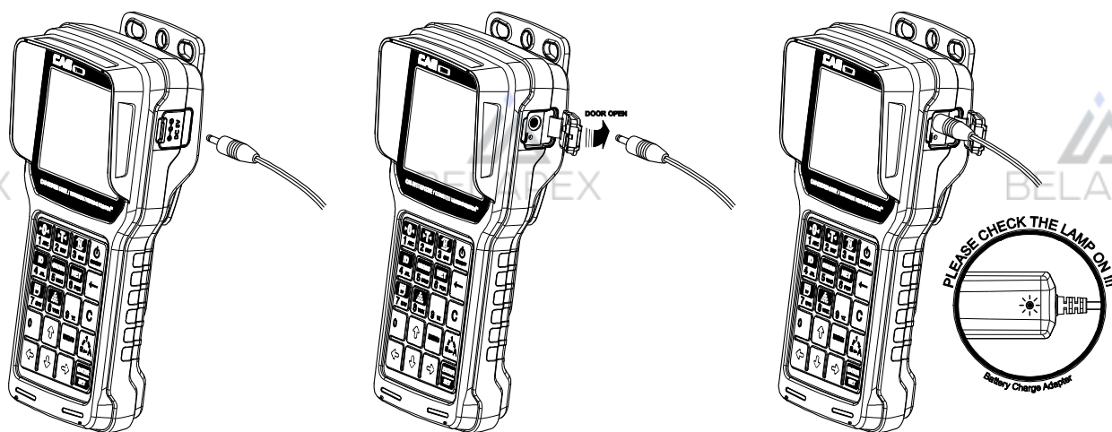
Рисунок 7.1 – Подключение адаптера для зарядки аккумулятора
